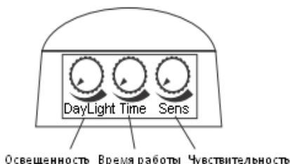
**DayLight** – настройка порогового значения освещенности, при которой происходит срабатывание датчика (от 0 до 30 лк);
