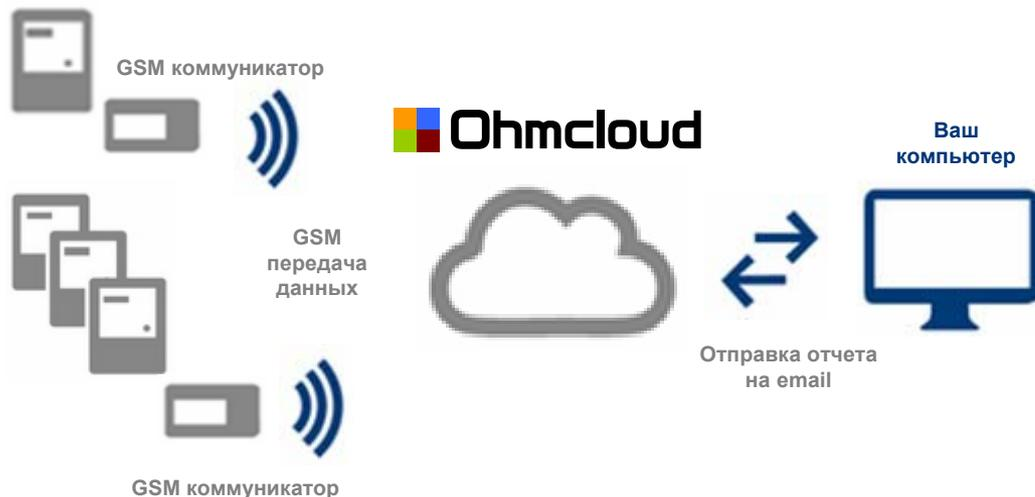
Сервер Ohmcloud ежедневно собирает с счетчиков, подключенных к GSM коммуникатору, данные о потреблении электроэнергии, получасовой профиль мощности и другие параметры, в зависимости от функционала используемого вами счетчика.
